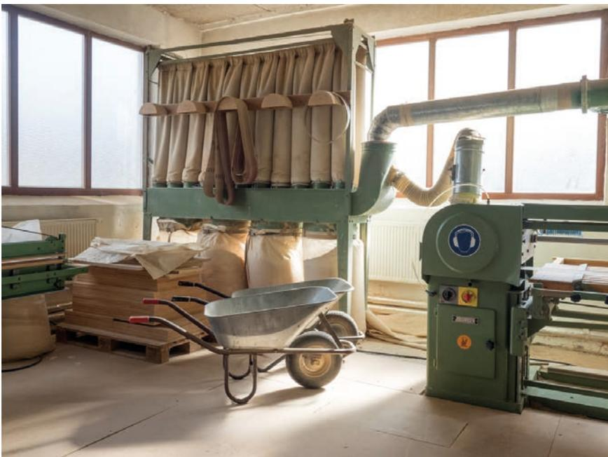
Absauganlage für Feinstaub mit 4 Staubsäcken
