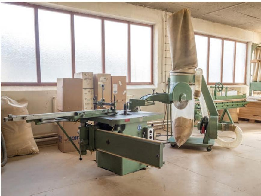
Schlitz- und Zapfenmaschine Bäuerle
